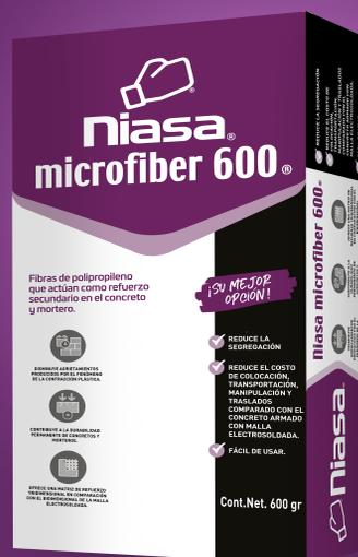
**Niasa microfiber 600** son fibras de polipropileno en forma de multifilamentos, que actúan como refuerzo secundario en el concreto y morteros, con la finalidad principal de reducir los agrietamientos producidos por contracción plástica en concretos en estado fresco y por temperatura en estado endurecido del concreto, contribuyendo a la durabilidad permanente de concretos y morteros.
