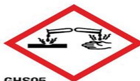
GHS05 Sustancias corrosivas (CR)
